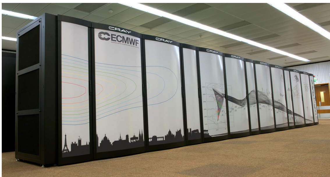
Рисунок 4.1 – Зовнішній вигляд одного із кластерів суперкомп'ютера Cray XC30.
