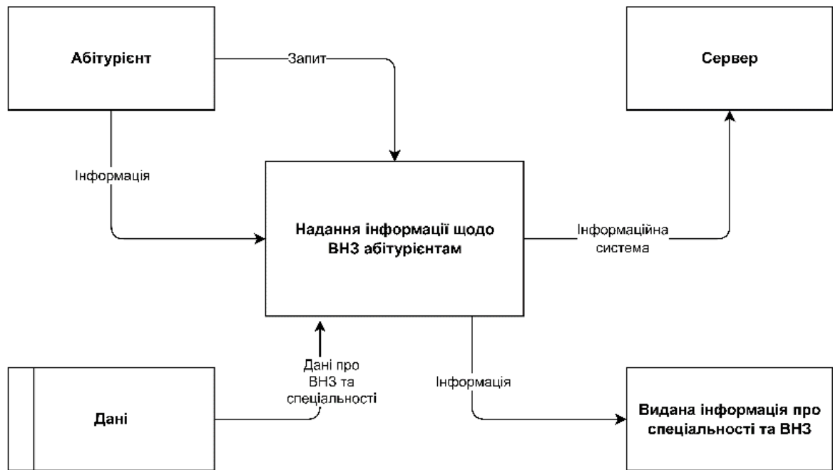
Рисунок 4.10 – Контекстна діаграма ІС для віртуального цифрового асистента для абітурієнтів
