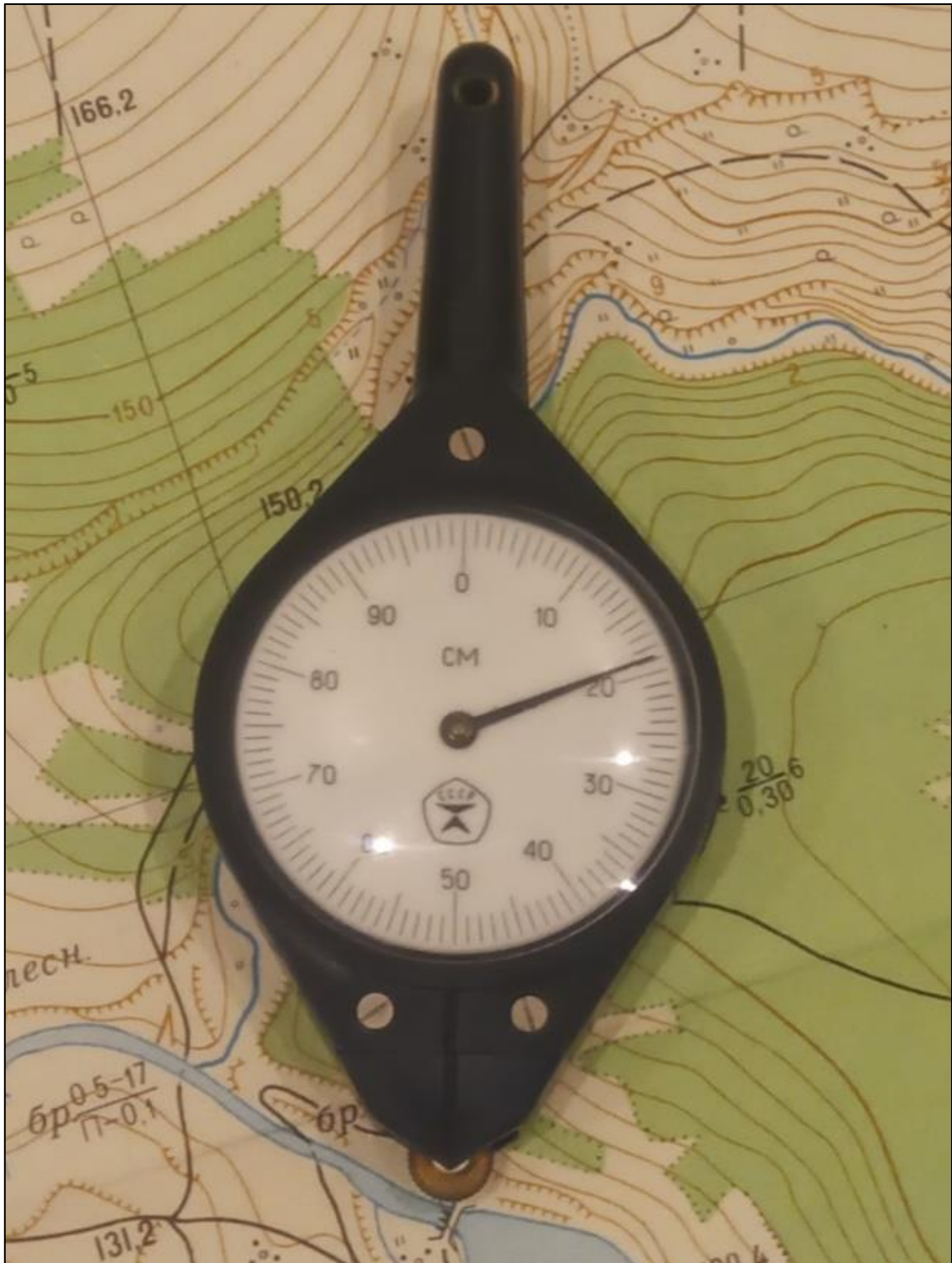
Рисунок Ж.3 – Варіант 3 вихідних даних для визначення довжин кривих (хвилястих) ліній на картах масштабів 1:5 000, 1:25 000, 1:100 000
