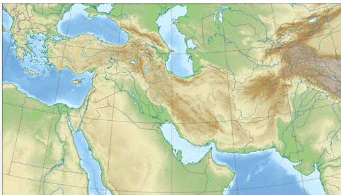
Рисунок 6.7 – Фрагмент фізичної карти, на якій за допомогою гіпсометричного забарвлення подана інформація про рельєф місцевості (зображення з сайту http://www.geoguide.com.ua )
