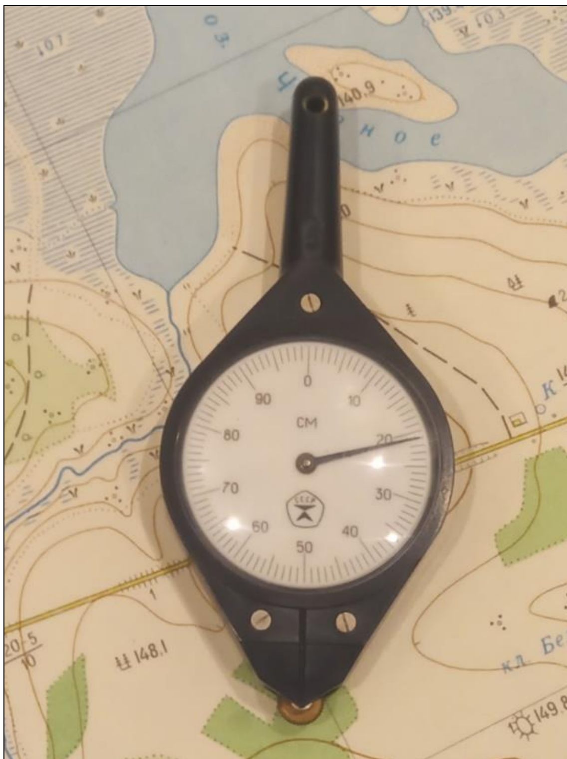
Рисунок Ж.4 – Варіант 4 вихідних даних для визначення довжин кривих (хвилястих) ліній на картах масштабів 1:10 000, 1:25 000, 1:50 000
