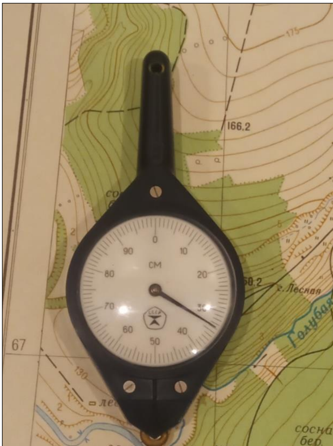
Рисунок Ж.5 – Варіант 5 вихідних даних для визначення довжин кривих (хвилястих) ліній на картах масштабів 1:5 000, 1:25 000, 1:100 000
