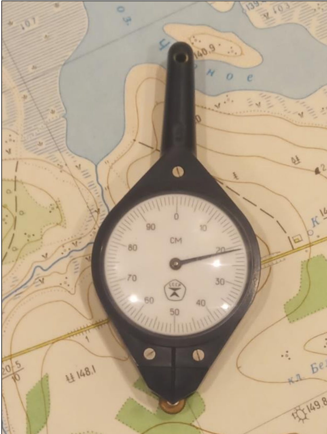
Рисунок Ж.1 – Варіант 1 вихідних даних для визначення довжин кривих (хвилястих) ліній на картах масштабів 1:5 000, 1:25 000, 1:100 000
