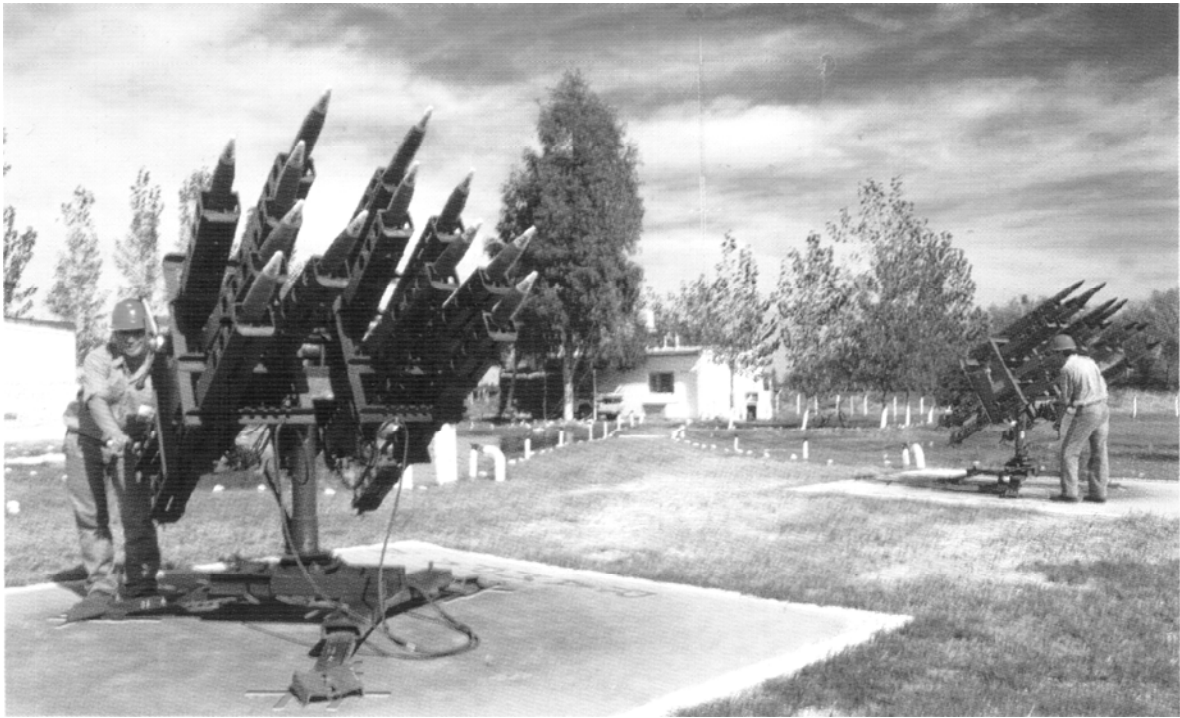
Рисунок 3.4 – Направляючі комплексу пускової установки
