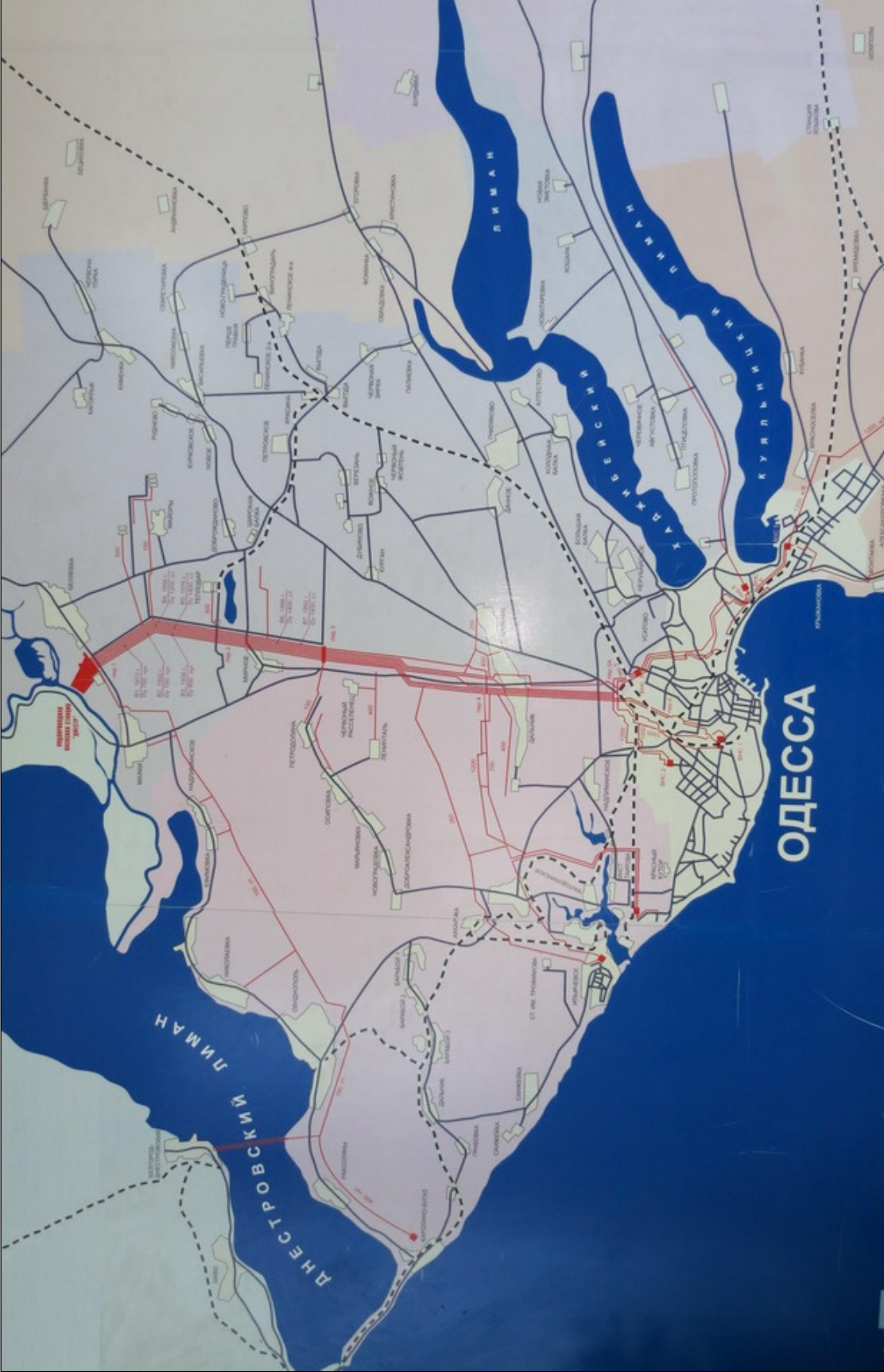
Рисунок 1.16 – Схема існуюча системи подачі питної води від ВОС «Дністер» до м. Одеса та інших населених пунктів області
