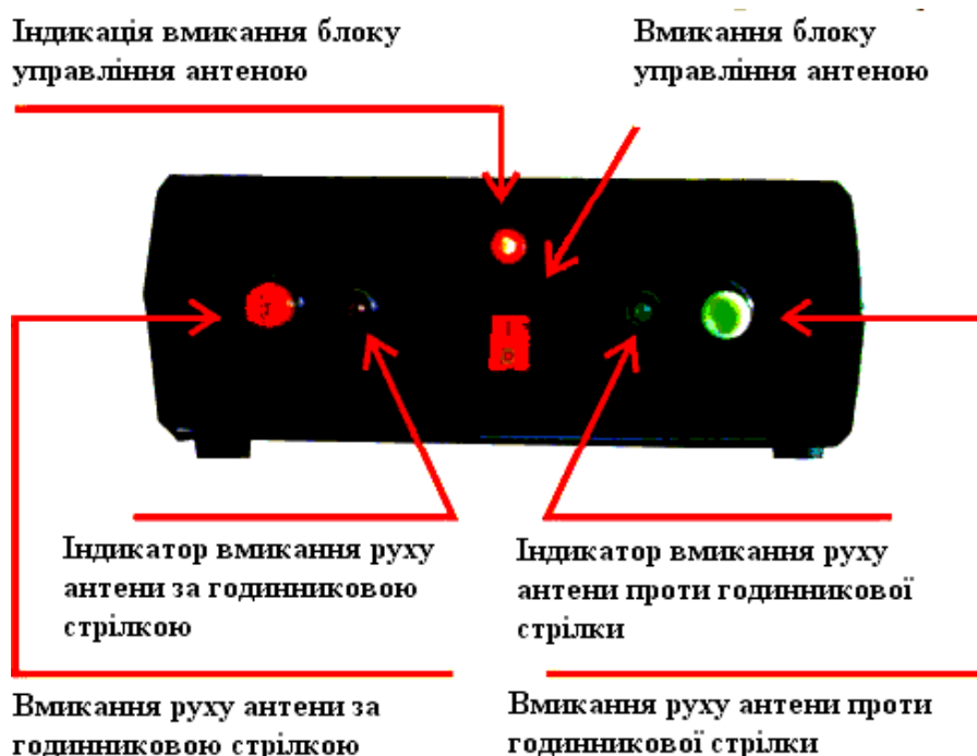
Рис. 2.4 – Елементи управління і індикації блоку управління антеною
