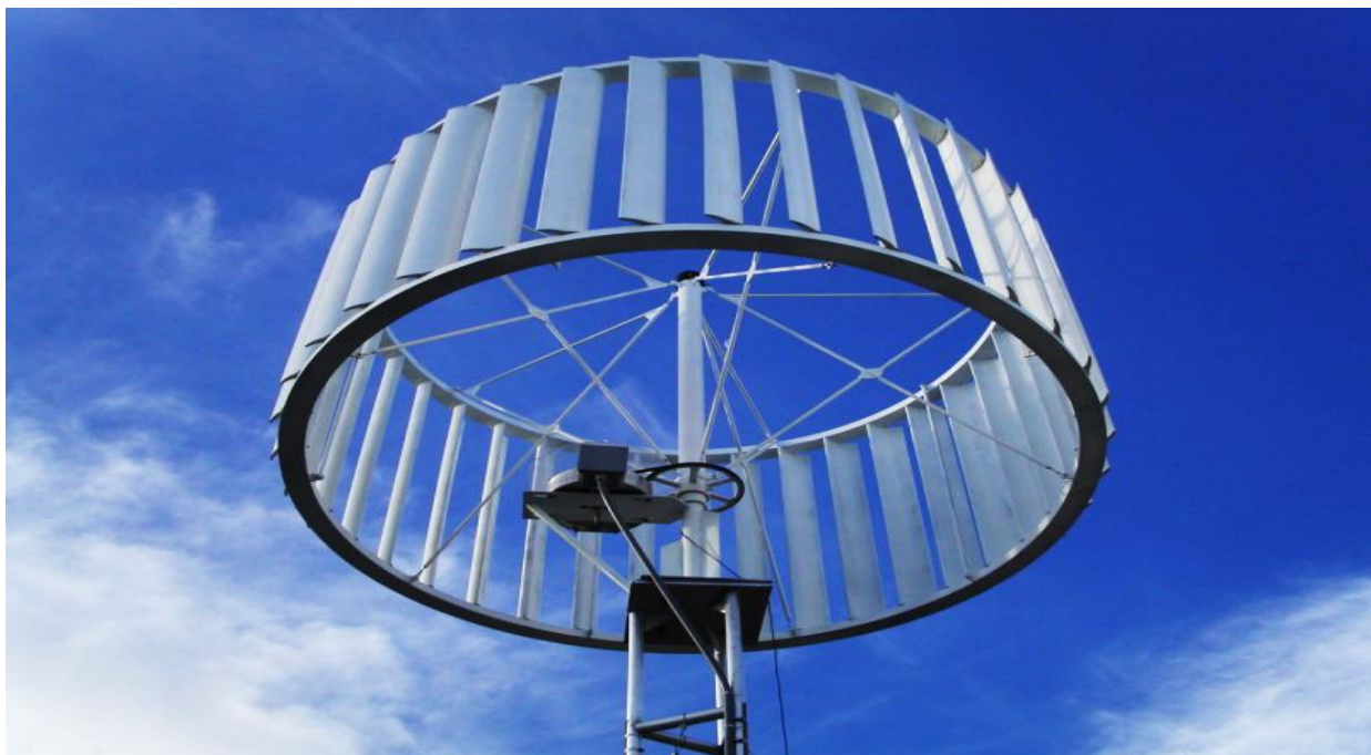
Рисунок 3.4 – Вертикальний вітрогенератор, ротор типу Бочка.
