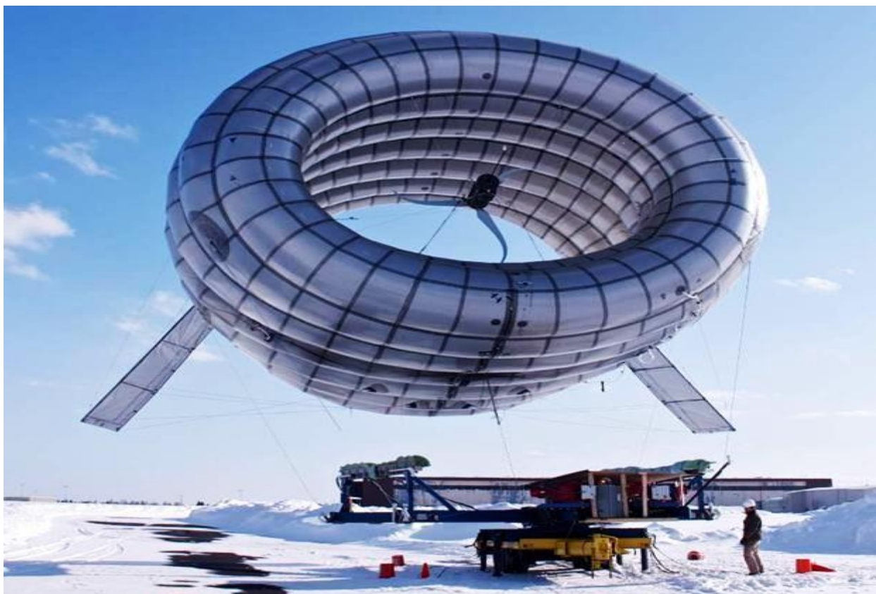
Рисунок 1.4 – Прототип висотного вітряка-дирижабля Airborne Wind Turbine розроблений компанією Altaeros Energies на польових випробуваннях у Алясці.
