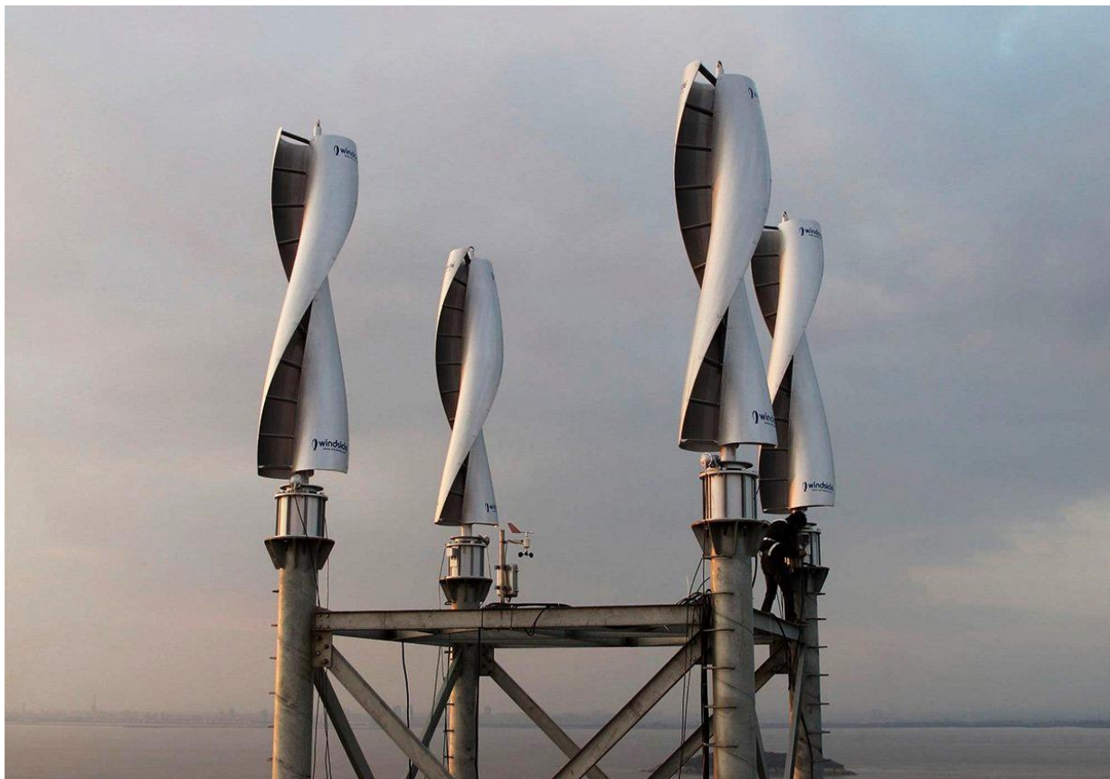
Рисунок 3.3 – Вертикальний вітрогенератор, ротор Савоніуса.
