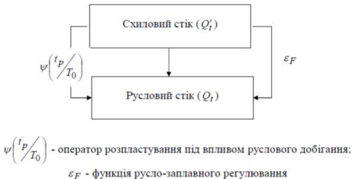
Рисунок 4.18 - Принципова схема формування руслового стоку [46]
