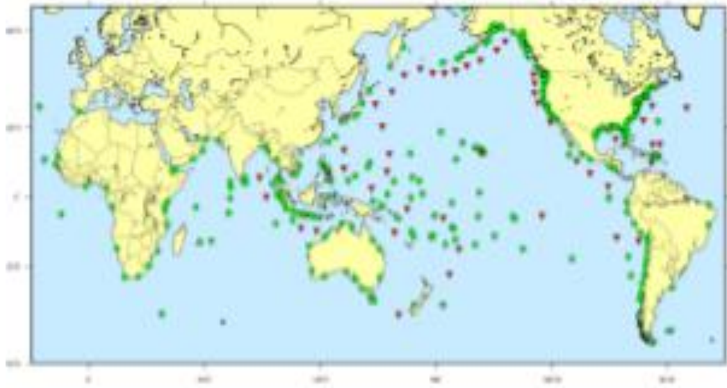
Рисунок 4.5 – Спостережна мережа регіональних систем попередження цунамі: зелені кружки - станції GLOSS, червоні трикутники- буї DART
