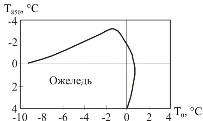
Рисунок 3.3 –Залежність формування фронтальної ожеледі від значень T_0 і T_{850}
