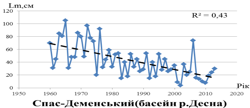
Рисунок 1.12 - Багаторічний хід максимальних глибин промерзання ґрунтів на рівнинній території України (басейн р. Десна)
