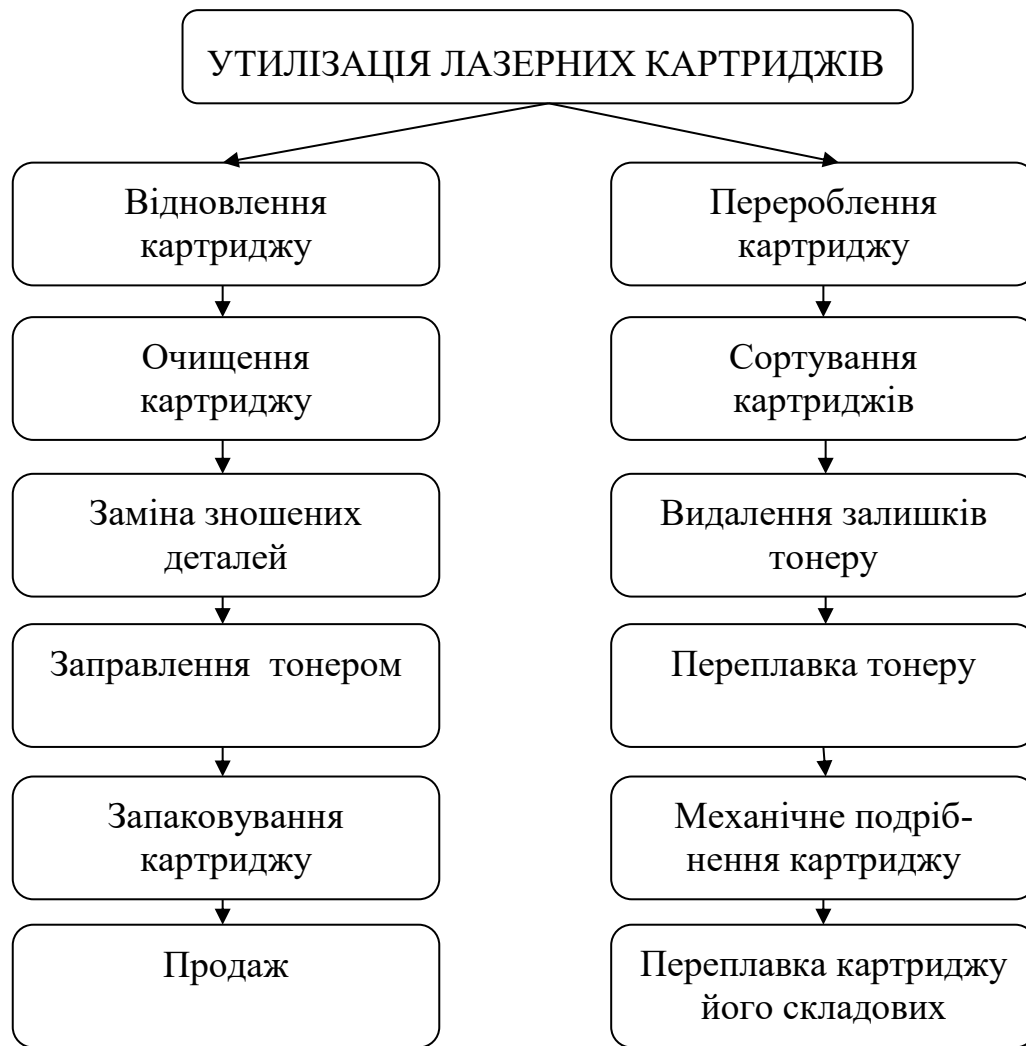
Рис. 3.12 – Етапи відновлення та перероблення лазерних картриджів
