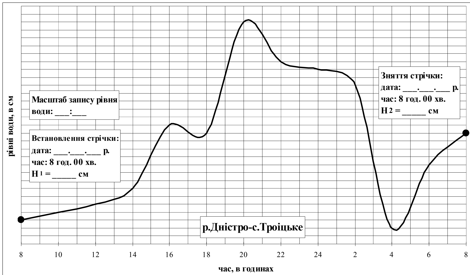
Рис. 1.7 – Запис добового ходу рівня води на стрічці СРВ “Валдай”, р. Дністро – с. Троїцьке ПРИМІТКА: 1 поділка по вертикальній шкалі на рисунку дорівнює 1 см по вертикальній шкалі на реальній стрічці.
