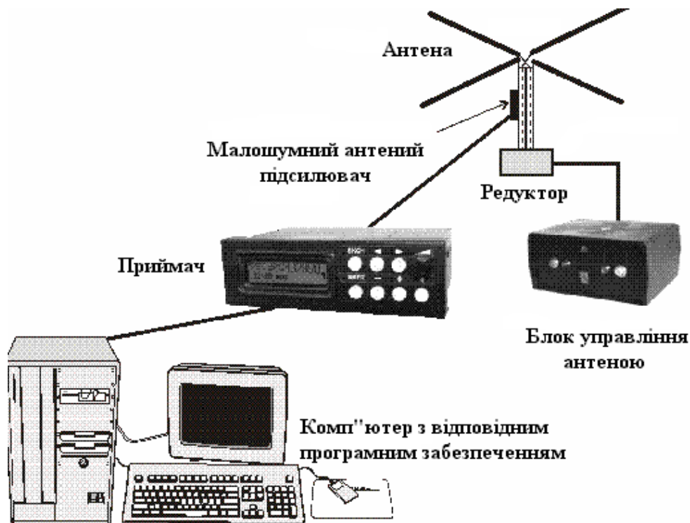
Рис. 3.1 – Склад станції КОСМЕК
