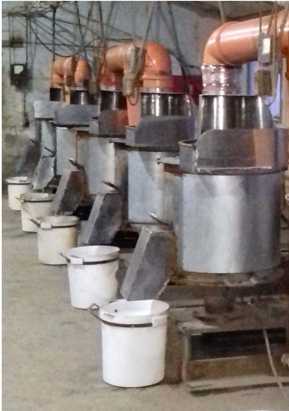
Рис. 2.13 - Апарат УДС-50 виробництва кормового борошна з риби
