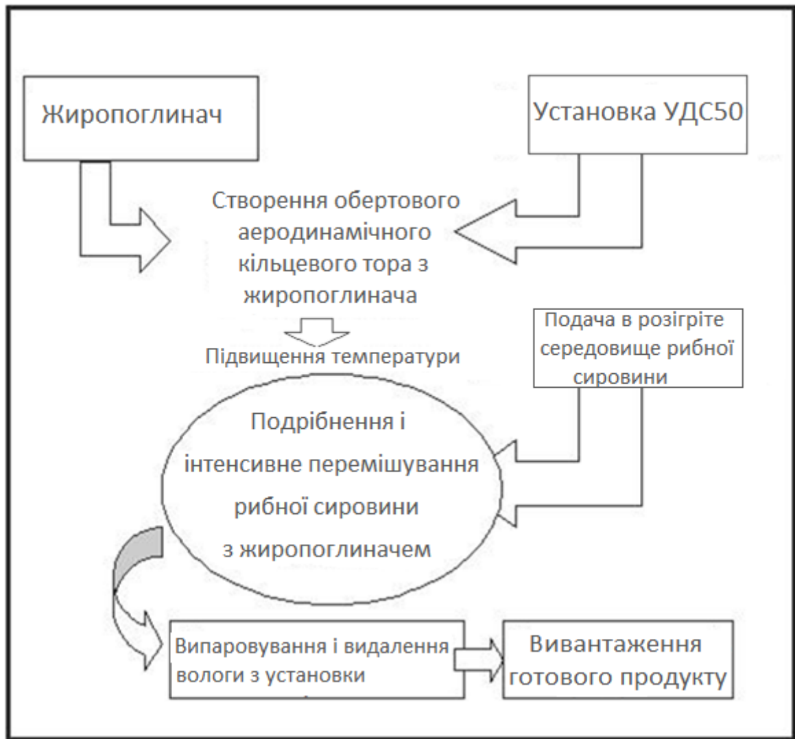
Рис. 2.14 – Схема технологічного процесу виготовлення рибного борошна
